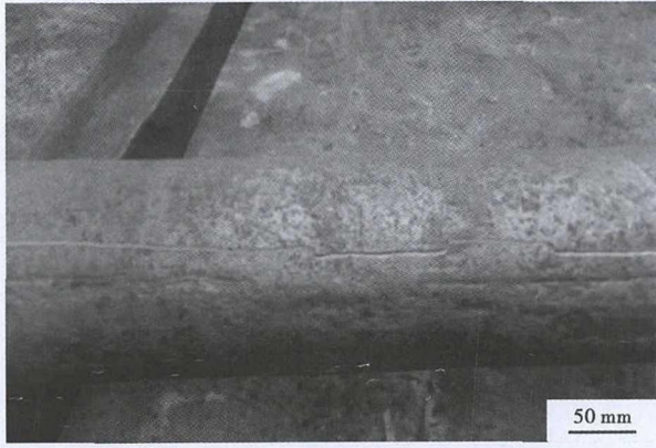
图3 17-4PH钢0.067% N的F炉次Φ150 mm锻材表面炸裂形貌
